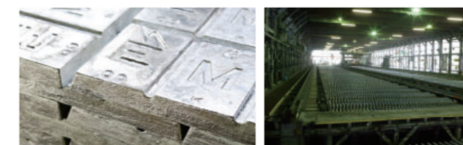
電気亜鉛 電気鉛(鉛電解工程)
